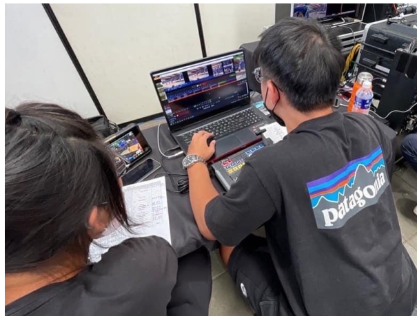
團隊成員操作回放控盤使用 vMix 多機位慢動作回放系統於轉播中即時播放
